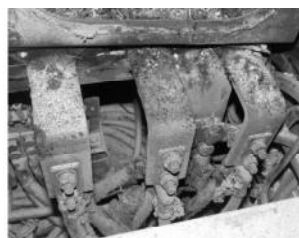
Fig.14 Cablaj de forță aferent releelor de curent maximal poz.54.1-3
