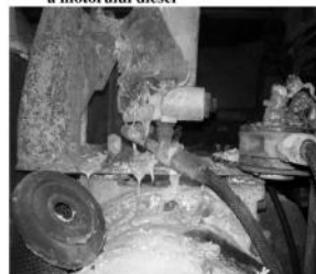
Fig.4 Carcasă topită a filtrului fin de motorină
