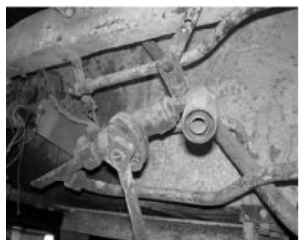
Fig.5 Robinetul cu trei căi poz.541 cu armătură superioară racord flexibil
